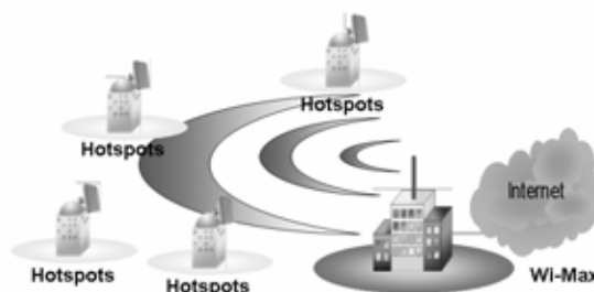
Figura 0.1 Modelo de una red IEEE 802.16
