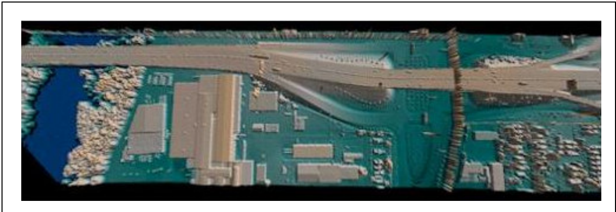
Figura 1.8 Ejemplo de mapas urbanos obtenidos a partir de datos LIDAR.
