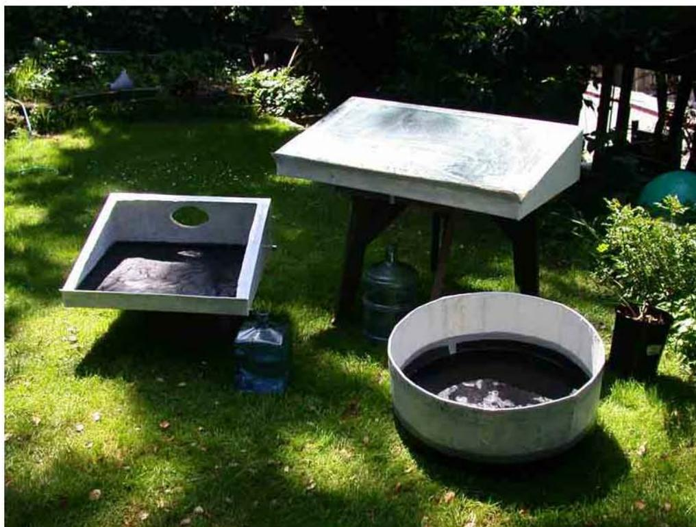
*Figura 5: Destiladores solares de fibra de vidrio.*
