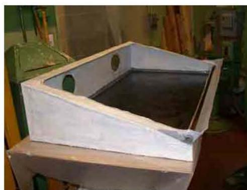
*Fig 4: Cubierta fibra de vidrio.*
