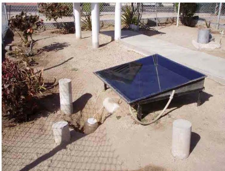
*Figura 6: Destilador solar instalado en el Observatorio*
