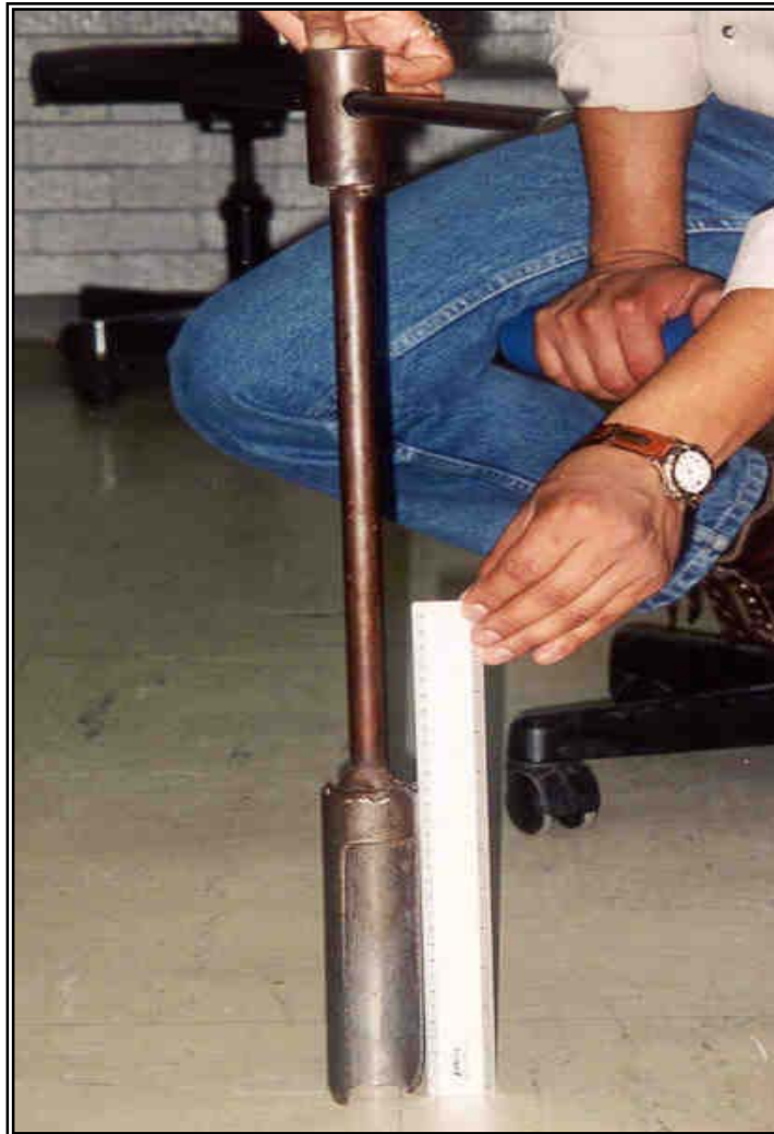
Figura 6.8. Nucleador para la toma de muestras compuestas.
