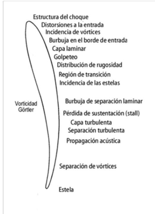
Figura 1.4: Esquema de los problemas presentes alrededor de la geometría de una pala de un compresor o turbina.
