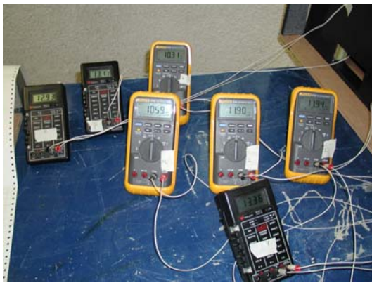
Figura 4.5.- Termómetro digital, multímetro digital y variac empleados en las pruebas experimentales
