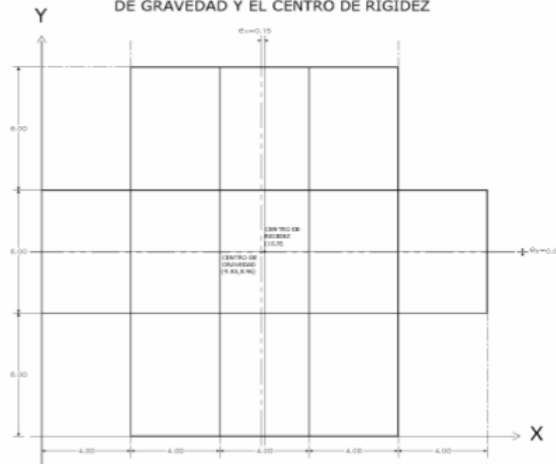
EXCENTRICIDADES ENTRE EL CENTRO DE GRAVEDAD Y EL CENTRO DE RIGIDEZ
