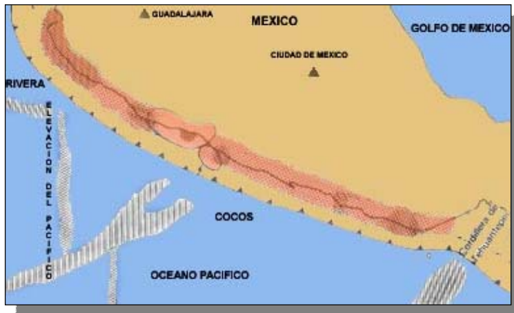
Figura 3-9 Mapa de placas tectónicas en México, zona del Pacífico. En el mapa pueden apreciarse las áreas de ruptura de algunos sismos, a lo largo de la costa del Pacífico. Estos han ocurrido debido a la subducción de las placas de Cocos y la Rivera bajo la placa continental mexicana. Servicio Sismológico Nacional. http://www.ssn.unam.mx
