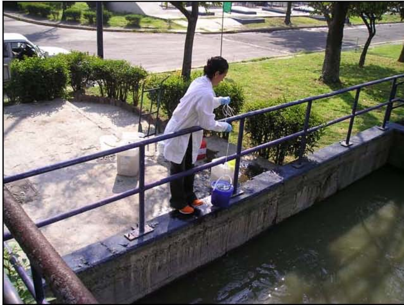
Fotografía 3. Muestreo de aguas residuales crudas directamente del influente de la planta de tratamiento de agua.
