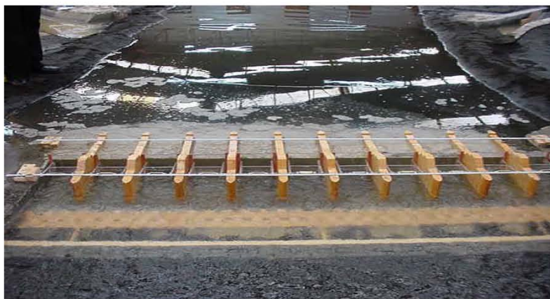
Figura 2.6.12 Funcionamiento del modelo físico con la estructura disipadora modificada.
