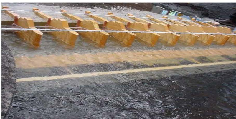
Foto 2.6.13 Funcionamiento del modelo prolongando el tanque amortiguador.
