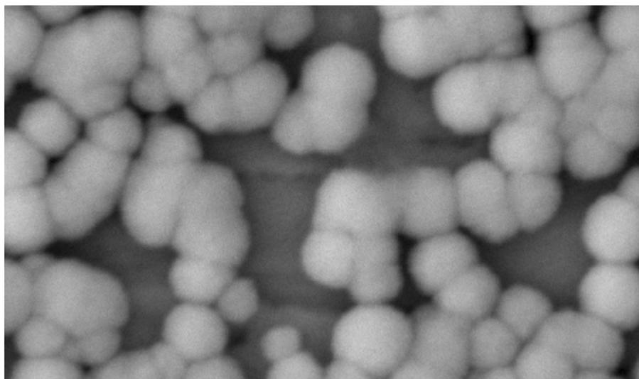
Figura 4.15 Imagen a 20 kV x 7000, 2  $\mu\text{m}$  del depósito de cobre sobre una placa de acero 1018 a partir de una solución de  $5 \times 10^{-2} \text{M}$  de  $\text{Cu}(\text{NH}_3)_4^{2+}$  y 1M de  $\text{NH}_3$  usando 1M de  $\text{NaNO}_3$  como electrolito.
