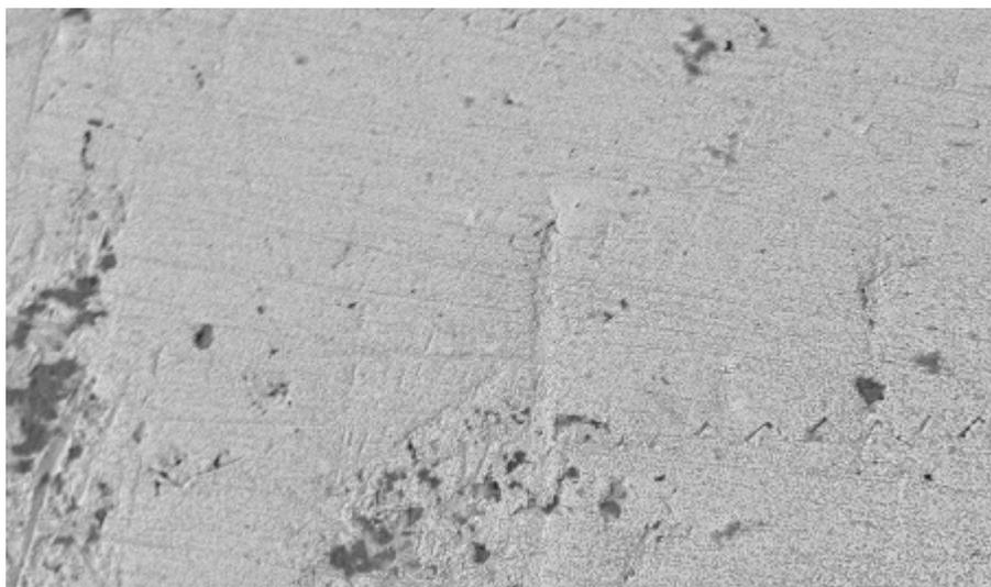
Figura 4.10 Imagen a 20 kV x 90, 200  $\mu\text{m}$  del depósito de cobre sobre una placa de acero 1018 a partir de una solución de  $5 \times 10^{-2} \text{M}$  de  $\text{Cu}(\text{NH}_3)_4^{2+}$  y 1M de  $\text{NH}_3$  usando 1M de  $\text{NaNO}_3$  como electrolito.
