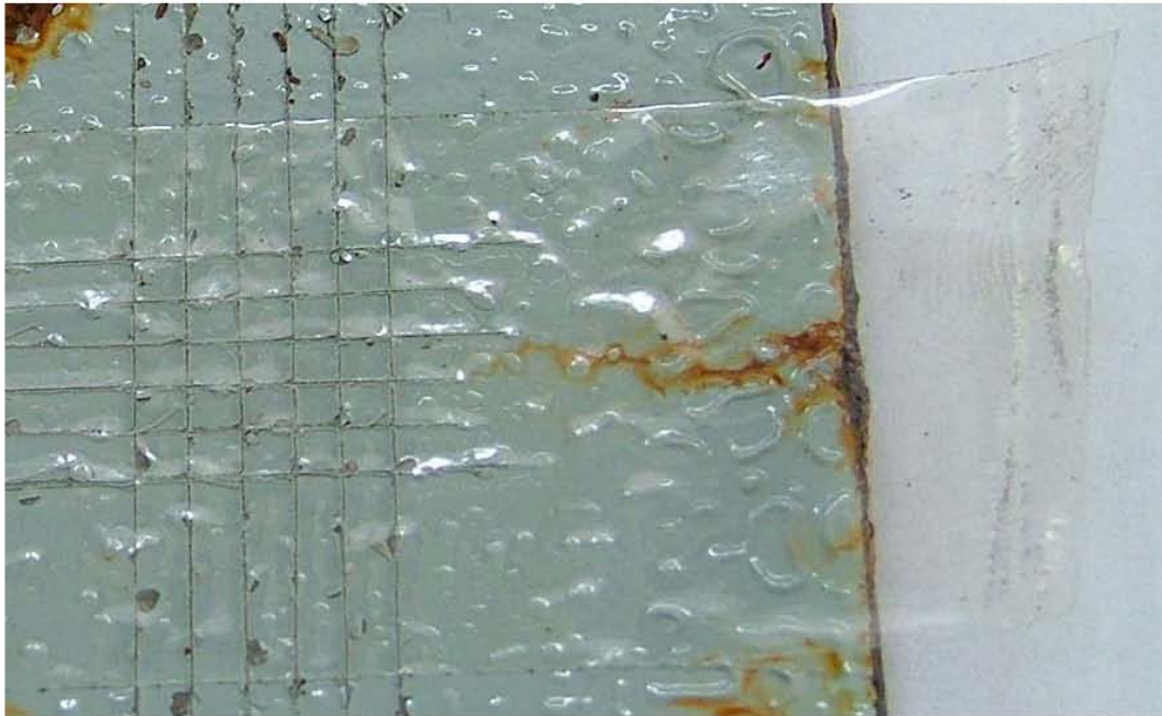
Figura 23 Cinta adhesiva sobre el rayado de una probeta de prueba.
