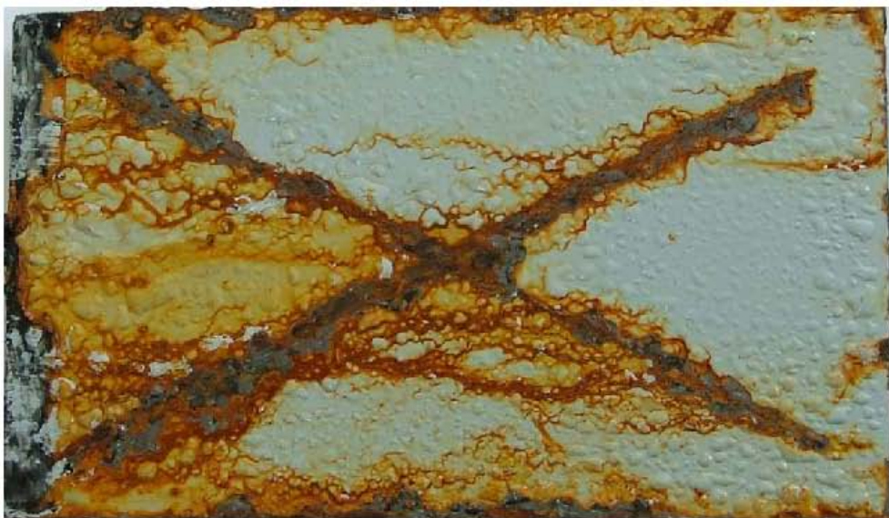
Figura 20 Evaluación de la oxidación de la probeta 14.
