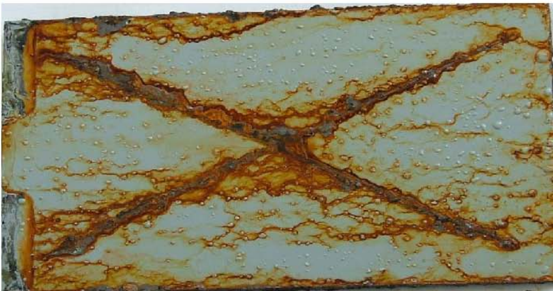
Figura 21 Comparación visual de la probeta 2, con la plantilla 4 del porcentaje de oxidación.
