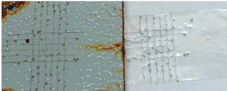
Figura 24 Separación de la cinta adhesiva de la probeta de prueba.
