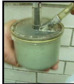
Mezclar el revestimiento especial IPS Empress ó el Revestimiento IPS Empress Speed según las instrucciones de uso. Controlar que se realice la mezcla con el nivel de vacío adecuado. La proporción de mezcla exacta de indica en las instrucciones de uso de revestimiento especial IPS Empress 2 o bien del revestimiento IPS Empress Speed.
