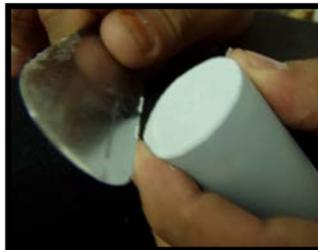
Una vez transcurrido el tiempo de fraguado indicado, retirar la guía de cilindro y la base con un movimiento giratorio. Retirar el pliego de papel. Eliminar los puntos de interferencia de la superficie de apoyo del cilindro con una espátula y comprobar que forma un ángulo de 90°
