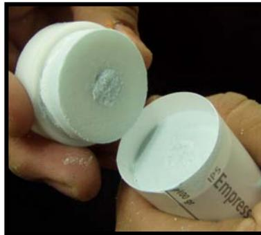
Antes de que frague el revestimiento, retirar el aro de estabilización y colocar con cuidado de guía en el cilindro con movimientos basculantes.
