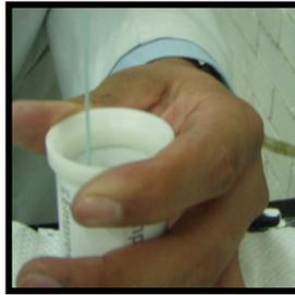
Rellenar el cilindro con el revestimiento hasta justo por debajo del aro de estabilización.
