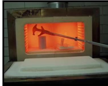
Introducir el portapastillas y el pistón de oxido de aluminio en el horno frío (sin las pastillas de IPS Empress 2).
