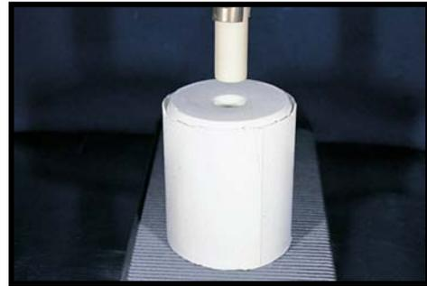
Concluido el ciclo de precalentamiento se extrae el cilindro del horno. Se le pone la pastilla para la técnica de capas. Seguidamente se coloca el pistón de AlOx
