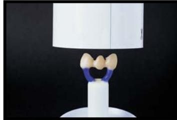
Los puntos de inserción en los bebederos en la pieza a inyectar o en el cilindro deben redondearse. Evitar los bordes pronunciados.
