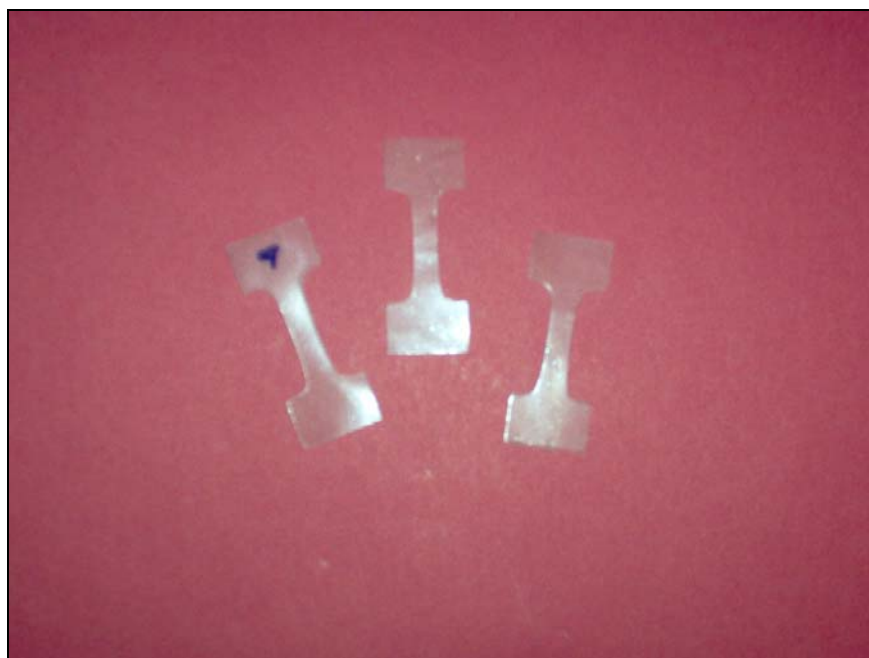
Figura 24. Fotografía digital de probetas de tracción cuajadas a partir de una película de nanocompuesto.
