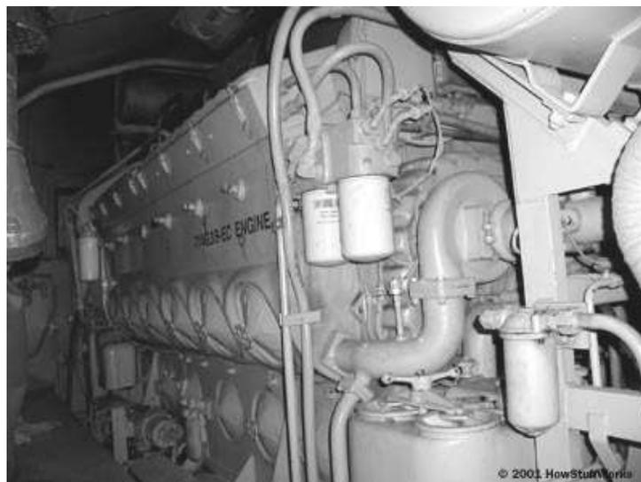
**Figura 1.8 Motor turbocargado V12.**
