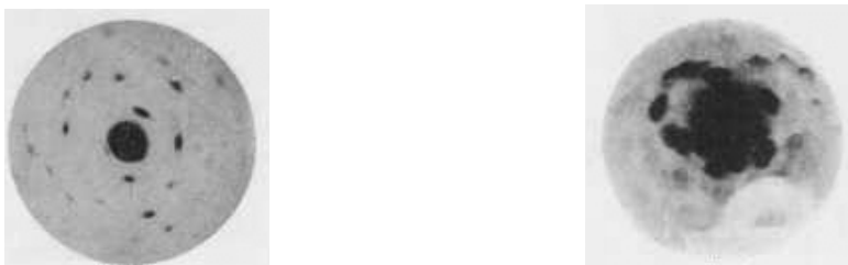
Figura 1 Fotografía Beerstein . Difracción del cristal de sulfato de cobre penta hidratado, tomada por Knipping, Friedrich y von Laue.
