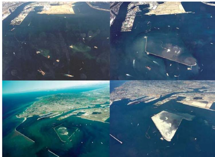
La diferencia de gradiente hidráulico entre el interior del depósito y el medio exterior es mucho menor que en los recintos construidos sobre tierra firme, por lo que el riesgo de filtraciones es más limitado.
