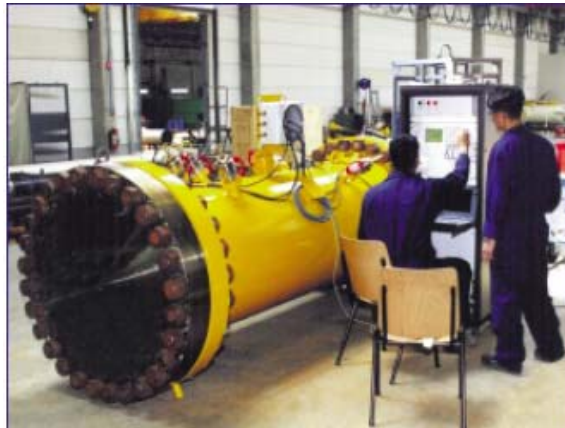
Fig. 4D. Calibración de Medidor de ultrasónico de Flujo en Laboratorio.
