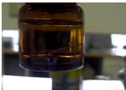
Imagen 3.- Frasco de vidrio color ambar con 10 mil de agua bidestilada y una punta de gutapercha en su interior.
