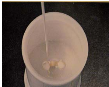
Fig. 42.- Rellenando el cilindro de silicón
