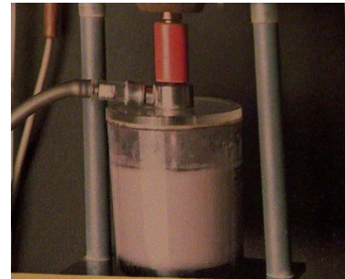
Fig. 41 Mezcla del revestimiento
