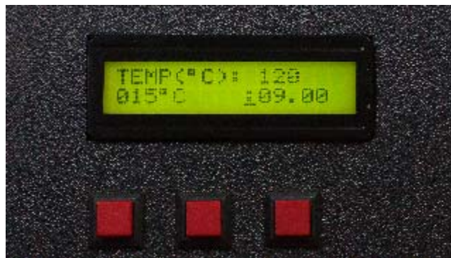
Figura 32. Ejemplo de temperatura sensada del horno de la máquina de termoformado y tiempo establecido.
