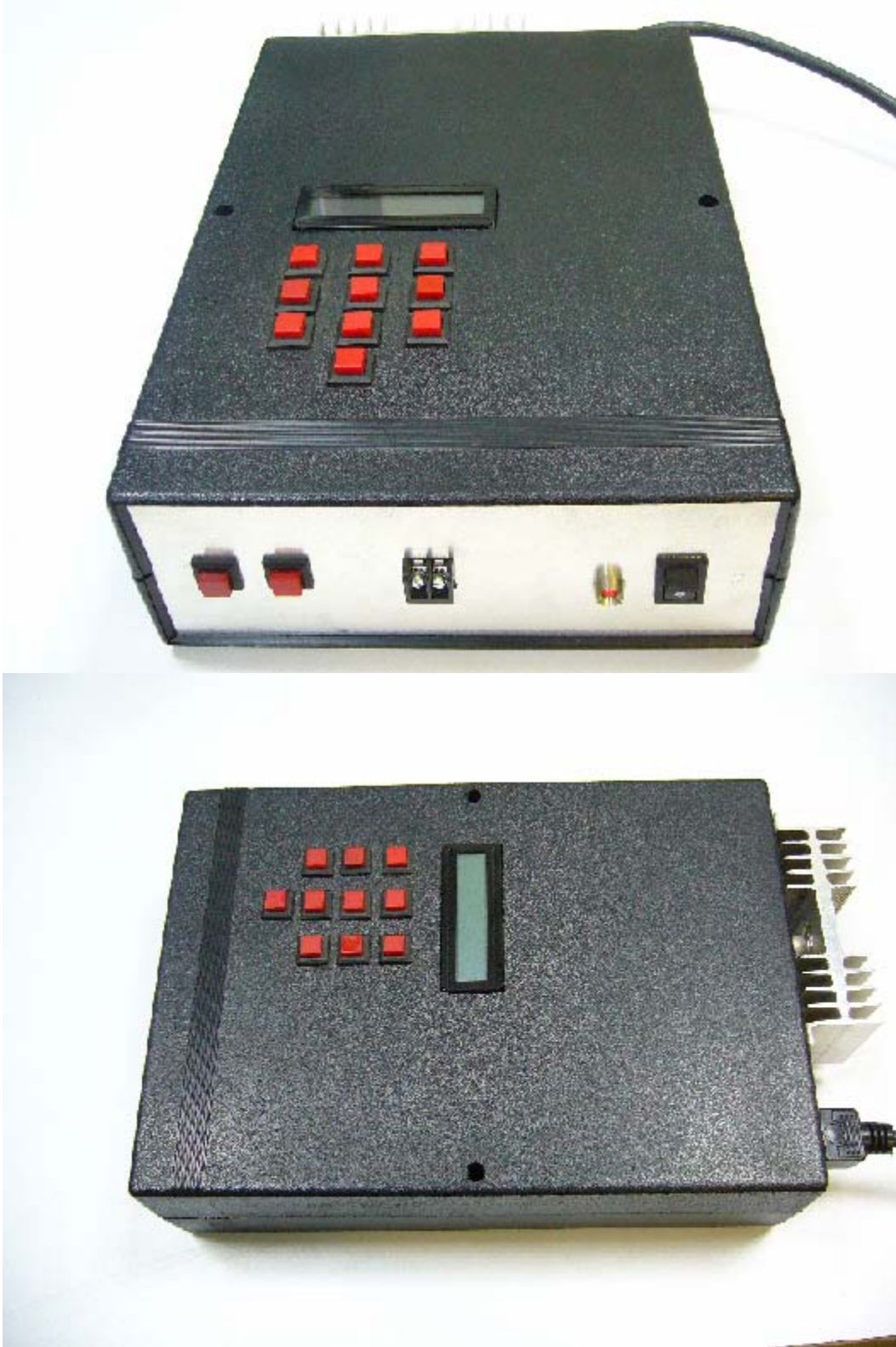
Figura 36. Vista exterior del control de temperatura desarrollado.
