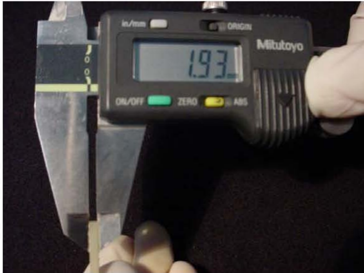
Figura 8. Medición de las dimensiones de la muestra
