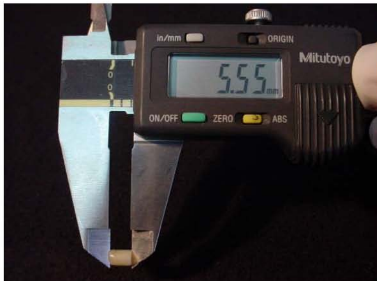
Figura 5. Medición de las dimensiones de la muestra
