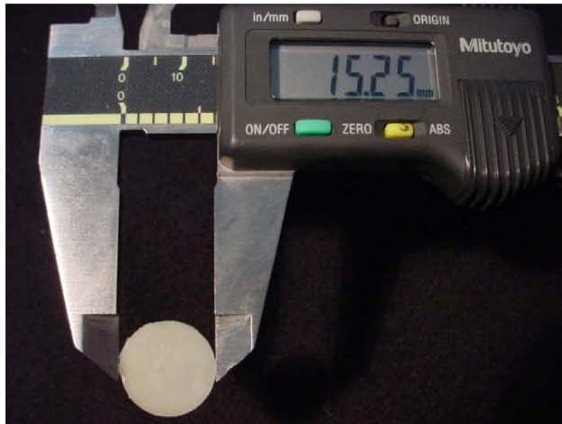
Figura 16. Medición de las dimensiones del espécimen
