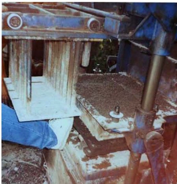
Figura 10. Proceso para la formación de los tabicones.
