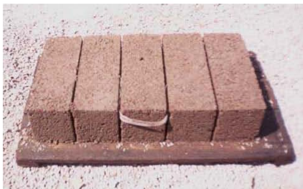
Figura 11. Secado de tabicones.
