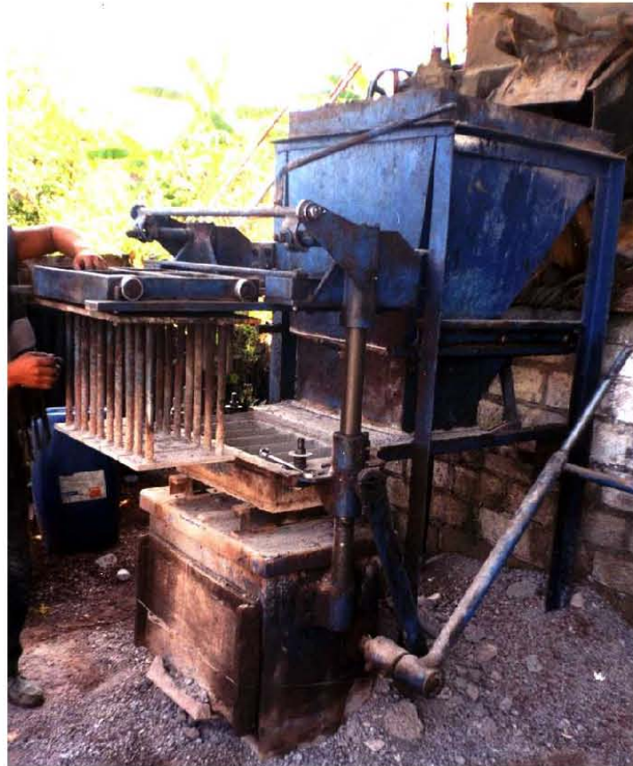
Figura 9. Equipo utilizado para la elaboración de tabicón.
