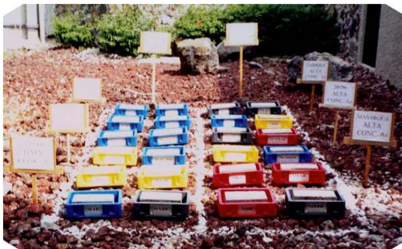
Figura 16. Arreglo de tabicones para la realización de la fase experimental.
