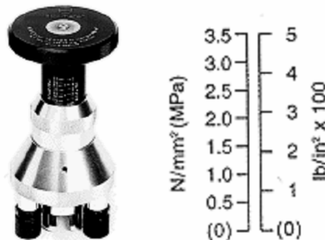
Foto 4 Probador de adherencia portátil ( método del Pull-off)
