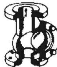
Figura 29. Válvula de retención de bola.
