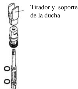
Figura 52. Despiece de un inversor manual.
