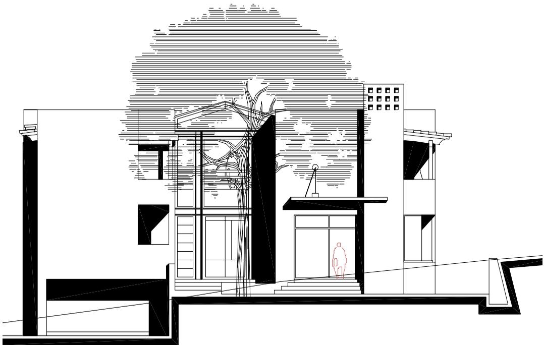
La composición de las fachadas esta determinada por dos volúmenes divididos por un cuerpo transparente. La fachada del lado Norte esta remarcado por el tiro de la chimenea como elemento vertical y una cubierta suspendida que se abre hacia el
