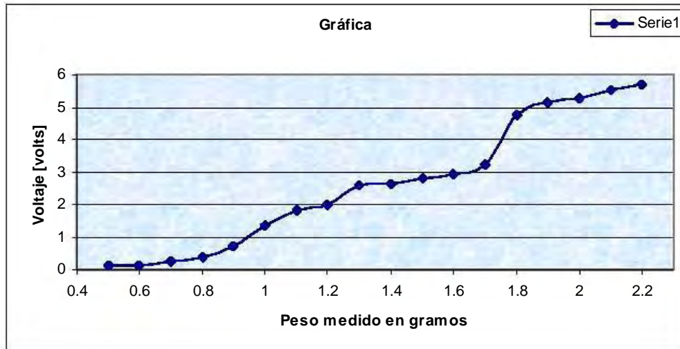
Figura 3.15. Gráfica de desplazamientos realizados con TiO_2 , podemos observar la variación de el voltaje (deflexión de haz láser captada por el sensor) con respecto a la sustancia agregada, observamos que el sistema presenta un comportamiento casi-lineal, es decir, con cada incremento de 0.1 [gramos], la respuesta del sistema fue creciendo de manera proporcional, gracias al nivel de sensibilidad que nos proporciona la técnica hasta alcanzar su punto máximo de voltaje.
