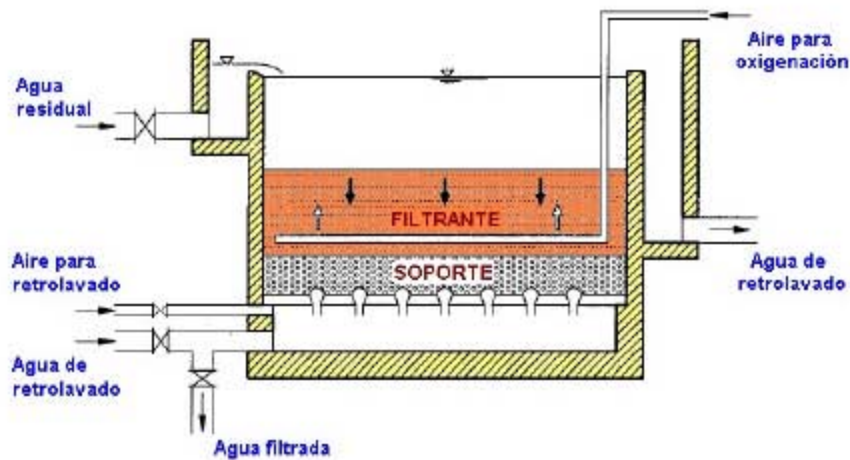
Figura 1.4 Diagrama básico del funcionamiento de un filtro biológico aerado, BAF por sus siglas en inglés (Degrémont, 2000).
