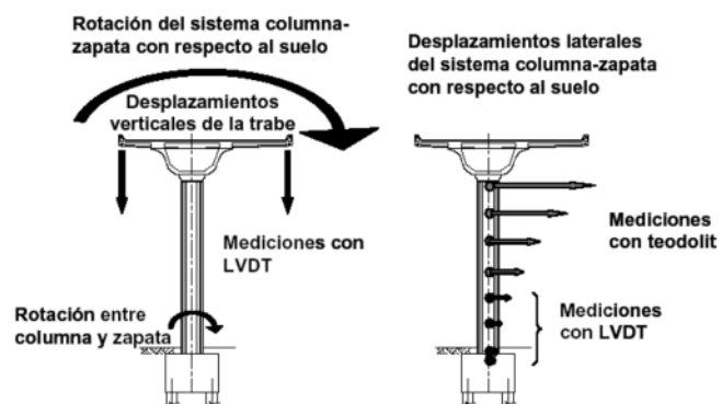
Fig. 4.1.12. Ilustración de las rotaciones y desplazamientos que se midieron en el sitio de Barranca del Muerto (IINGEN 2005)
