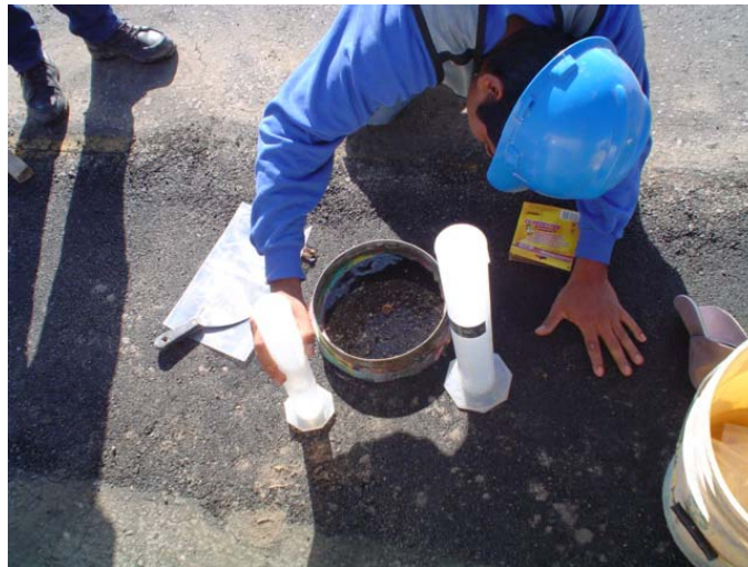
Fotografía I.12.- Prueba para determinar la permeabilidad de la carpeta asfáltica.
