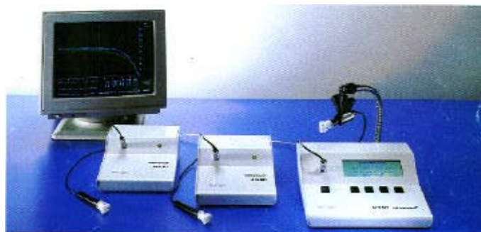
Fig. 12 Tewameter Courage-Khazaka TM 210 ® . En el podemos apreciar el dispositivo que es colocado en el antebrazo de los voluntarios para obtener las medidas de pérdida de agua transepidermal.
