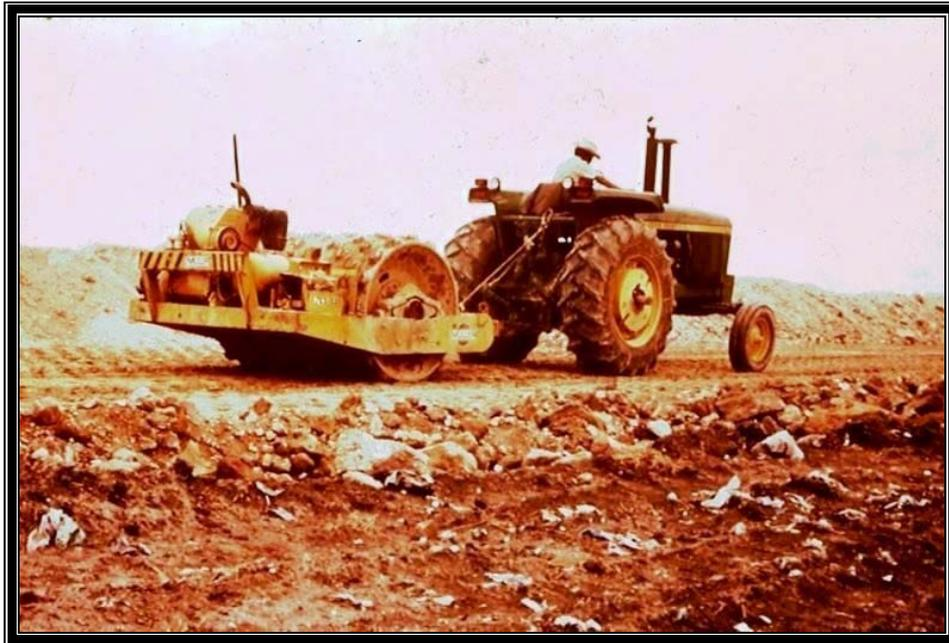
**Figura 26. Rodillo Pata de Cabra Vibratoria.**
