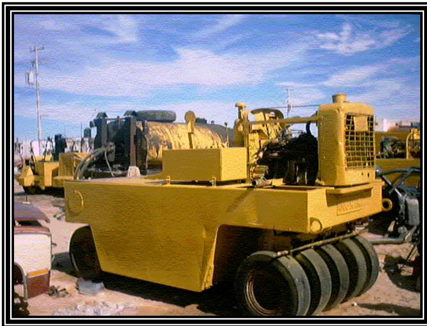
**Figura 11. Compactador de neumáticos de llantas pequeñas.**
