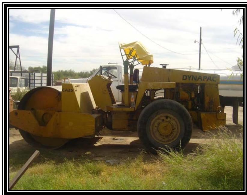
**Figura 25. Rodillo Vibratorio liso autopulsado, combinado con neumáticos.**
