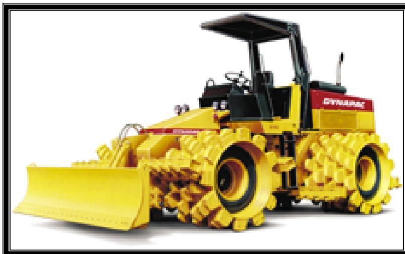
Figura 23. Rodillo de Impacto (Tamping Roller)
