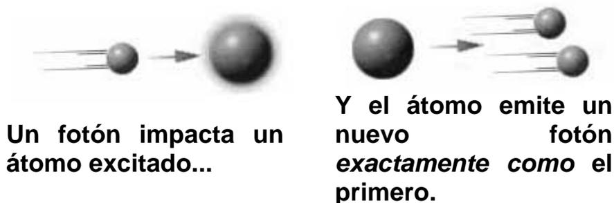
5. **Ampliación de la luz.** Si un foton hace caer a un electrón a un nivel de energía bajo, el electrón emite un foton en la misma dirección
