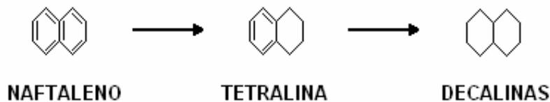
Figura 5.10 Esquema simplificado de la reacción de hidrogenación de naftaleno.
