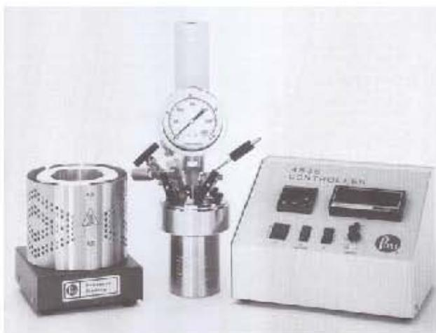
Figura 4.2 Reactor batch empleado en la evaluación catalítica
