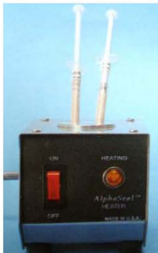
Fig. 3.4. Jeringas de multi-Phase I y II en el calentador.
