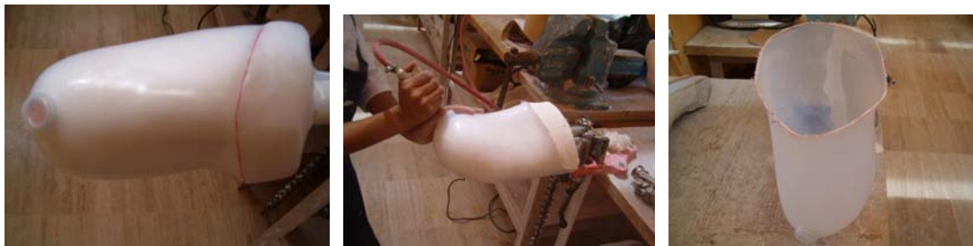
Figura 3.19. Extracción del socket de la escayola
