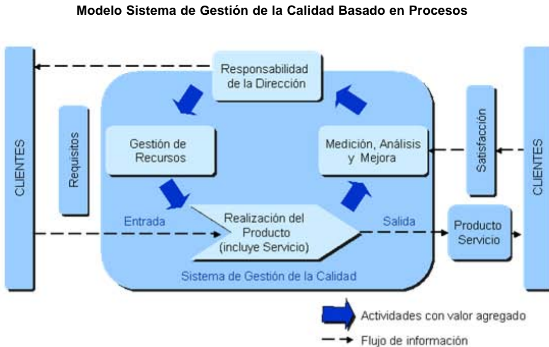
Figura 5.2. Muestra el modelo de gestión de la calidad basada en procesos, de conformidad por lo señalado en la versión 2000 de ISO 9000.
