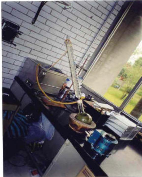
Figura. 6. Obtención del extracto acuoso de *C. edulis* mediante un sistema de reflujo.
