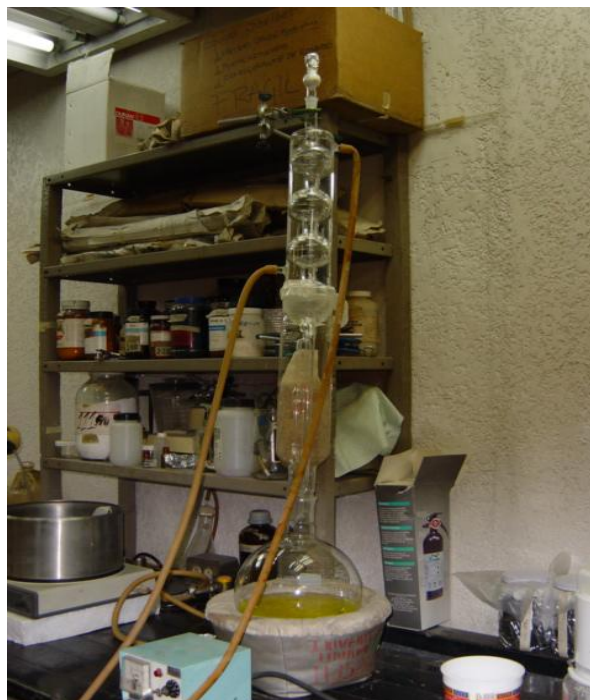
Fig. 12. Extracción de alcaloides a partir de semillas de E. herbacea con un equipo Soxhlet (FOTO: Garín-Aguilar, 2004)
