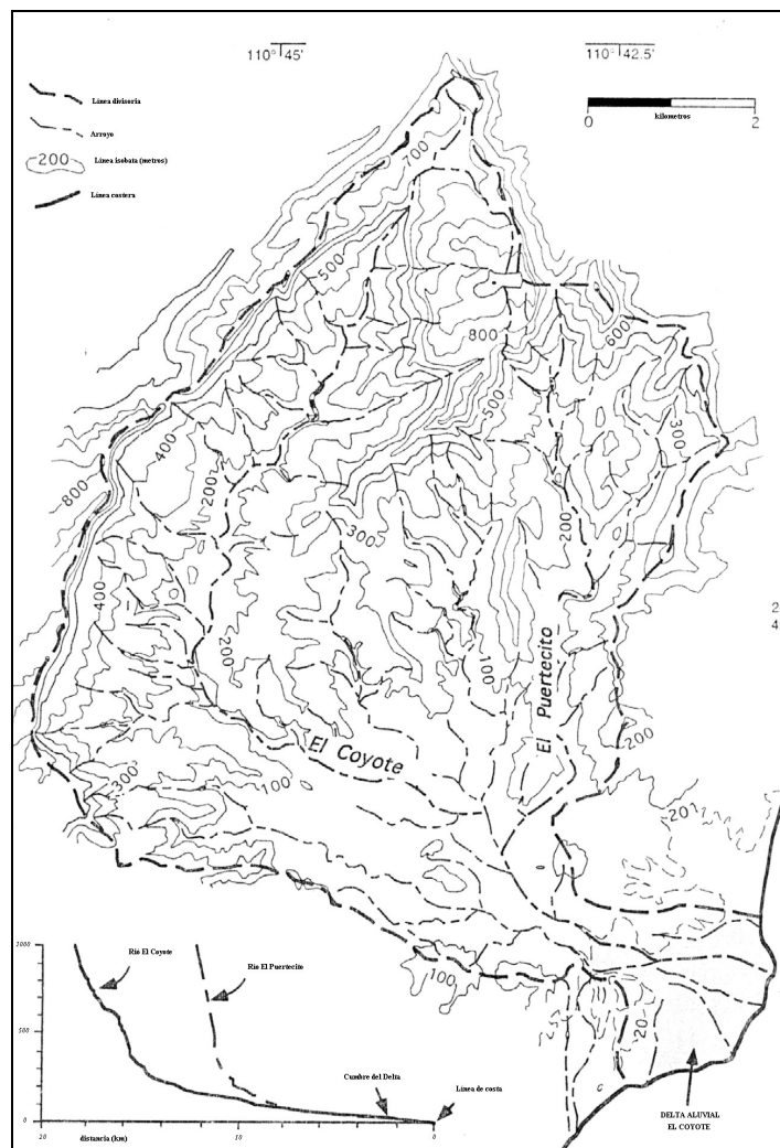
Figura 7. Cuenca hidrológica Coyote y perfiles longitudinales de los ríos El Coyote y El Puertecito.
