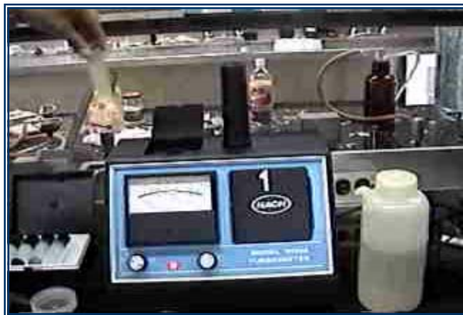
Figura 3.15. Turbidímetro Modelo 2100A HACH.
