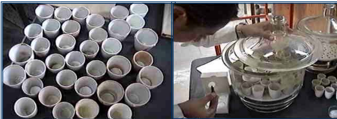
Figura 3.12. Crisoles para determinar Sólidos Filtrables.
