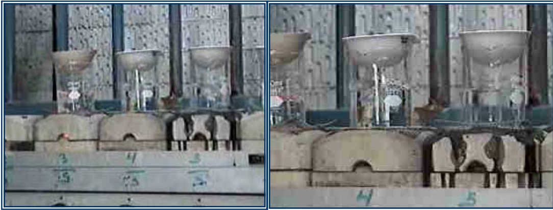
Figura 3.11. Cápsulas de porcelana para la determinación de Sólidos Suspendedos Totales.
