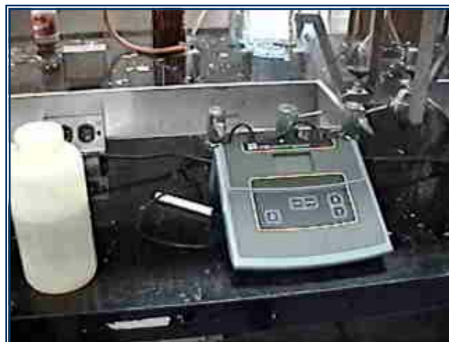
Figura 3.17. Conductivímetro Conductivity Instrument 3100, YSI.
