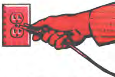
Figura 1.2. El conductor eléctrico que se presenta en esta figura es un cable alimentador de energía (mejor conocido como: cable toma corriente).
