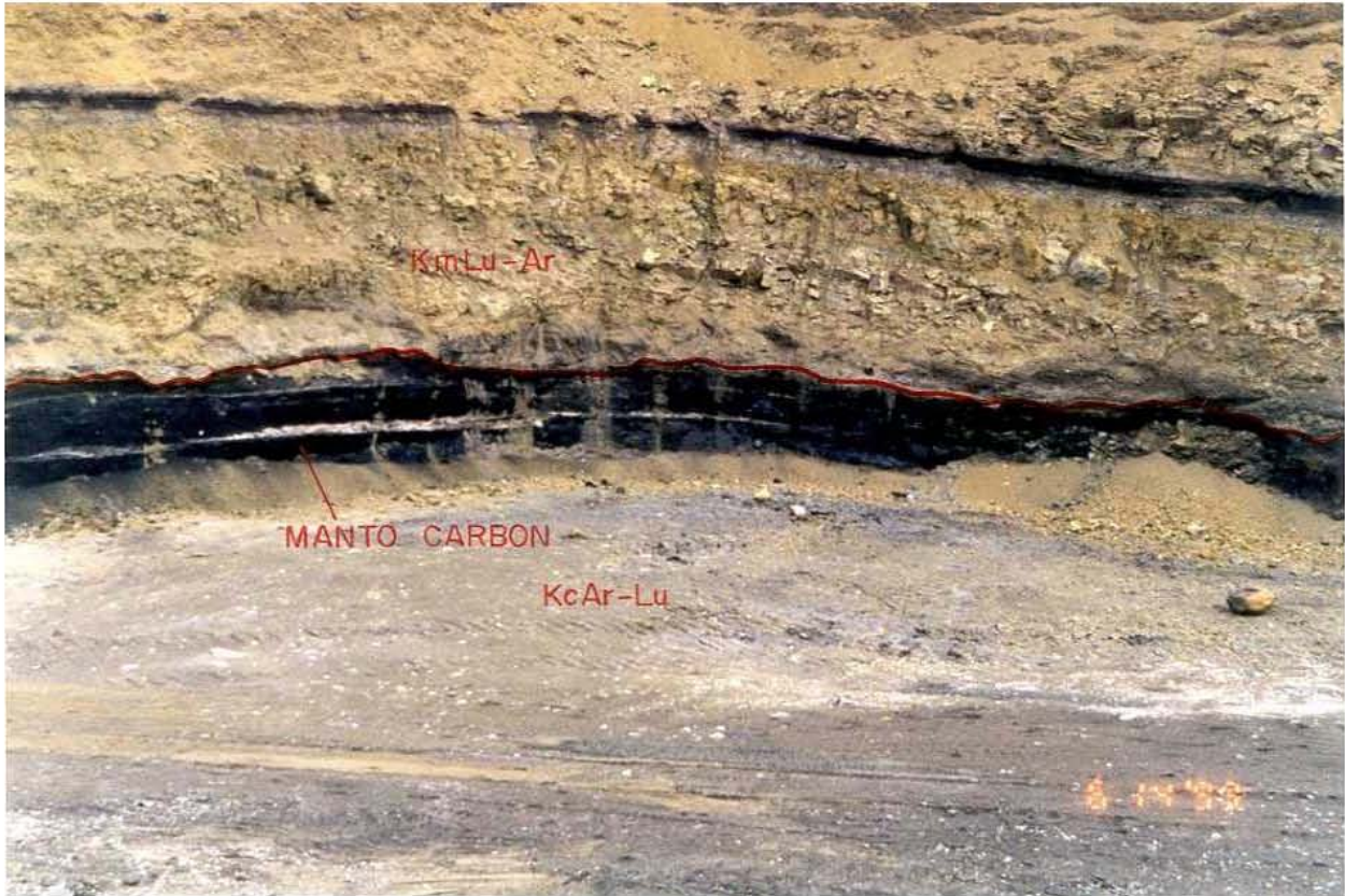
Fotografía 14.- Tajo Esperanzas, donde se aprecia el manto de carbón y las formaciones encajonantes Olmos – San Miguel.
