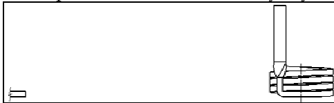
Figura 1-15. Etapa 5 Terminación del conformado de la espiral.
