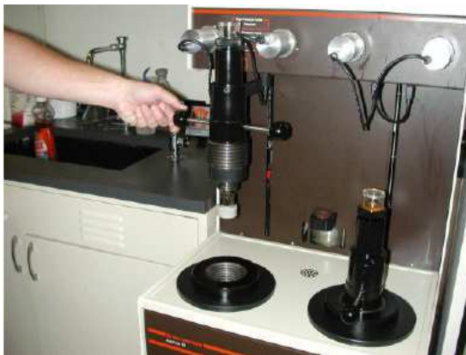
Figura 4.10. Cámara de vacío para la inyección de mercurio.
