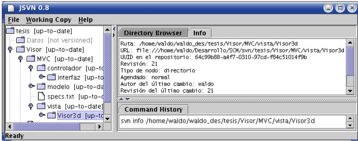
Figura 3.2. Subversion (SVN). Permite establecer el control de versiones del código fuente mediante *revisiones*; la interfaz gráfica JSVN facilita su uso. SVN (<http://subversion.tigris.org>) y JSVN (<http://jsvn.alternatecomputing.com>) se distribuyen bajo *licencias de código-abierto (open-source)*.
