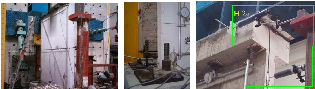
Figura 2.12 Instrumentación externa, transductor de carátula, transductores de vástago
