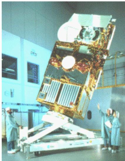
*ERS-2 en el cuarto limpio en centro técnico de la ESA en Noordwijk, en los Países Bajos. Las antenas del SAR y el generador solar se doblan para arriba y se embalan contra el satélite en la "configuración del lanzamiento".*
