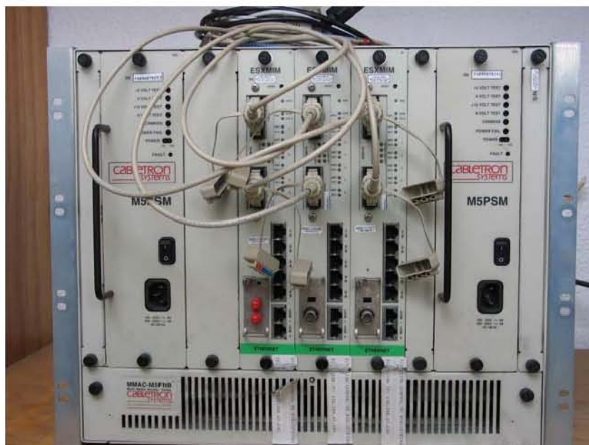
Figura 4b. Switch Cabletron para trabajo a 10 Mbps a backbone e interconexión con la RedUNAM
