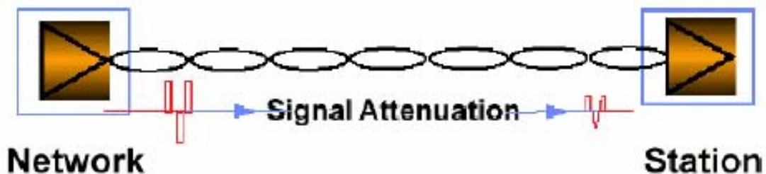
Figura 3.3h. Representación de la atenuación que sufre la señal al pasar por el par cruzado de cobre.
