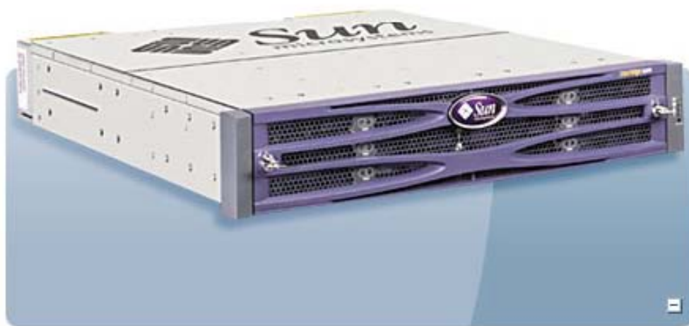
Figura 4.1a.. Nueva adquisición de equipos de respaldo, con combinación de discos de Fibra, SCSI y SATA, con capacidad máxima de 3.6 TB.
