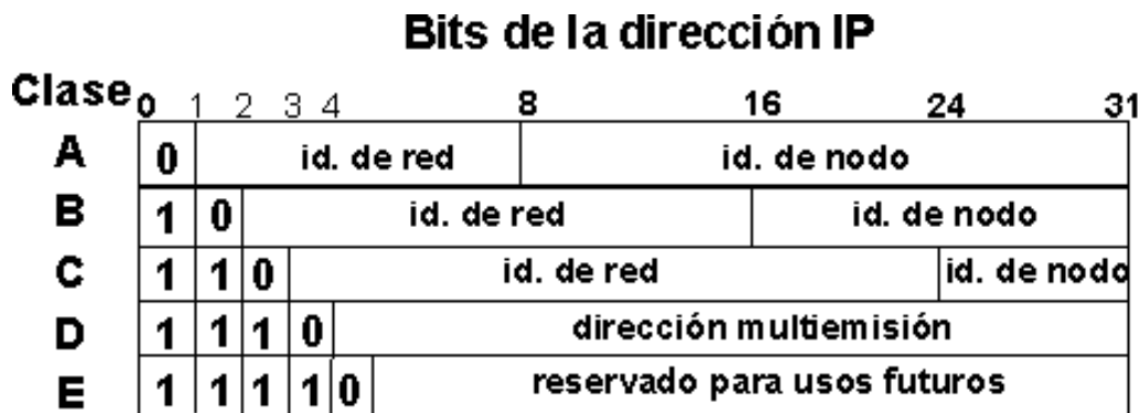
Figura 2.3e. Tramas de las clases de direcciones I.P.
