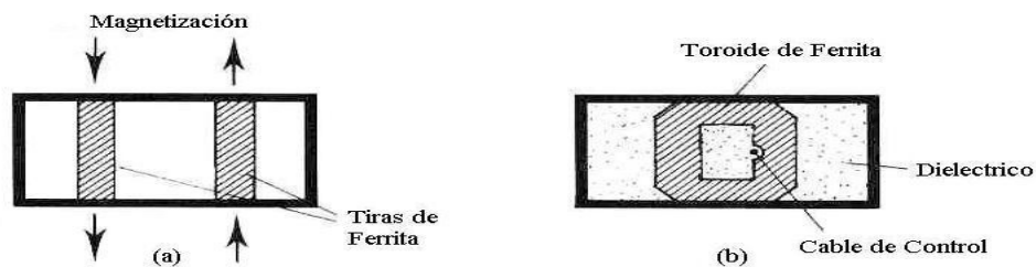
Figura 1.3 Desplazador de fase de ferrita: (a) tiras gemelas; (b) toroidal.
