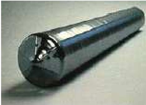
Figura 2.4: Lingote de silicio monocristalino
