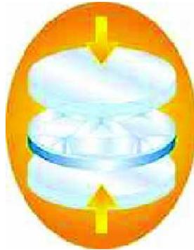
Figura 2.26: Unión directa o por fusión de dos obleas de silicio: temperatura a 800°C
