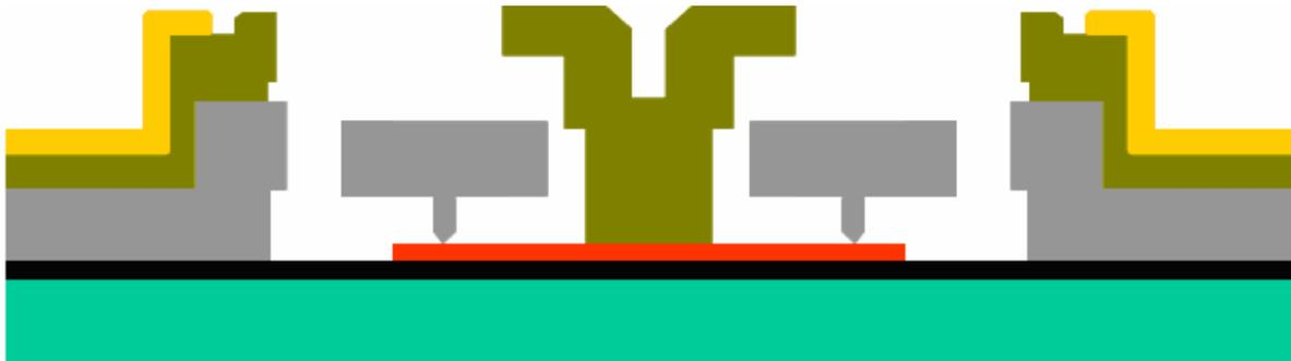
Figura 2.28 Estructura PolyMUMPs liberada y con depósito de oro.
